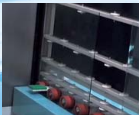
SECTION PRE'-LAVAGE MODULO DE PRELAVADO
