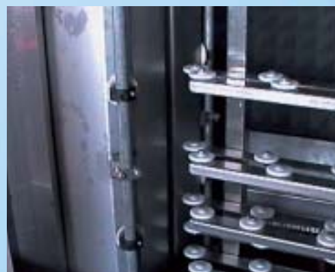
PARTICULARITES VUE INTERNE Structure totalement en acier inox. PARTICULAR VISTA INTERIOR Estructura totalmente en acero inoxidable.
